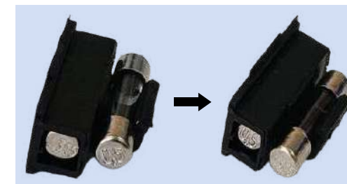
4) Substituir o fusível de fora do compartimento pelo fusível de dentro do compartimento e encaixar o porta-fusível novamente no equipamento.
