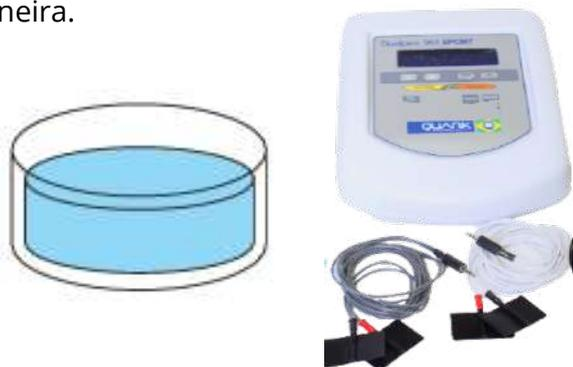
**ATENÇÃO:** Caso não possua eletrodos de silicone, o teste pode ser realizado somente com o equipamento, cabo (s) e recipiente com água.
